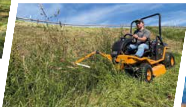
Insektenschonendes Mähen mit Scheuchvorrichtung
