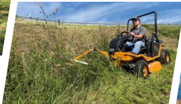
Insektenschonendes Mähen mit Scheuchvorrichtung
