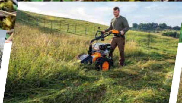
Schonender Schnitt mit Doppelmesser-Mähbalken
