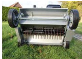
Am Fliehkraftsystem aufgehängte, gehärtete 3mm Vertikutiermesser
