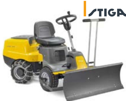
Schneeschild Park 300 Serie mit 107 cm Räumbreite, Gummileiste, links und rechts schwenkbar mit Anbaurahmen
