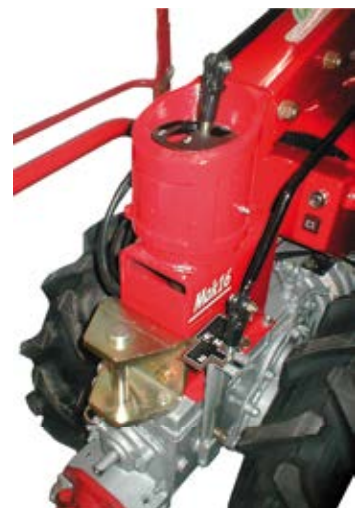
Schaltkulis, Anhängerkupplung + Zapfwelleneinstellung MAK 17
