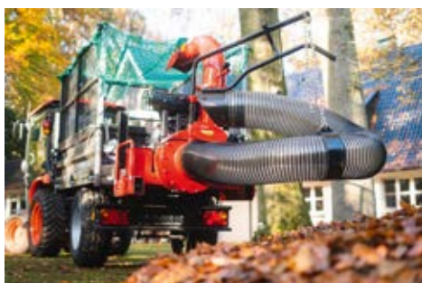
Schlauchhalterung für den Transport
