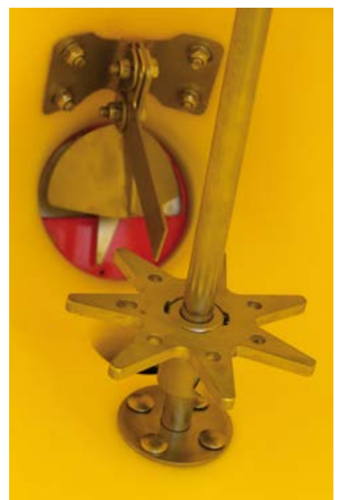
zusätzliches Rührwerk gegen Brückenbildung
