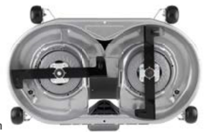
▲ Mähdeck mit synchron laufenden Messern
