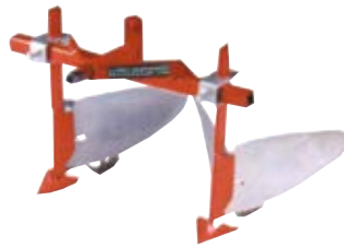
Häufelkörper 2-reihig Spindelkopfstück erforderlich
