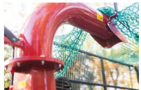
Schwenkbarer Auswurfkanal und verstellbare Auswurfklappe
