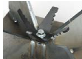
Piranha-Messer zur Volumenreduzierung
