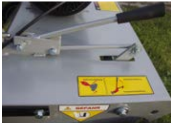
Stabiler Absenkmechanismus mit Feinjustierung
