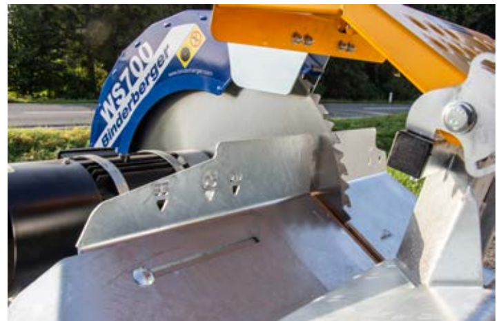
Wippe mit Schutzkäfig und eingelassenen Längsmarkierungen
