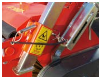
Abstellstütze und stufenlos höhenverstellbare Kehrwalze
