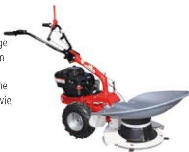
M220 mit Scheibenmäherwerk und Schwadttuch (ohne Abb.)
