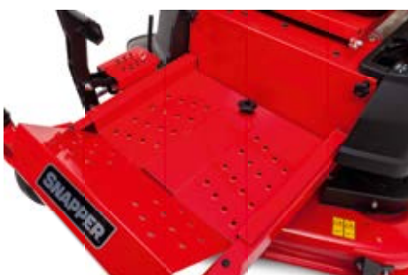
Abnehmbare Bodenplatte für einfachen Wartungszugang
