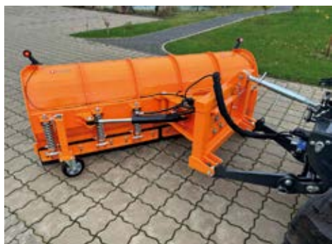
Federklappen als Überfahrtschutz, höhenverstellbare Stützräder
