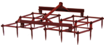
Anbauegge Spindelkopfstück erforderlich
