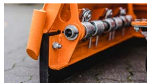
Federklappenelemente mit Gummileiste
