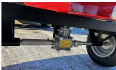
Verstärktes Metallgetriebe mit zuschaltbarem Freilauf für Überführungsfahrten
