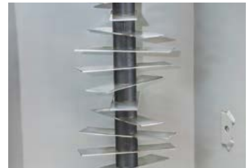
Kugelgelagerte Vertikutierwelle mit gehärteten Doppelstahlklingen
