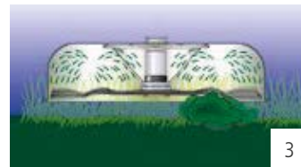
Scherschrauben brechen, Absorber-Einheit verschiebt und verdreht sich auf dem Messerhalter
