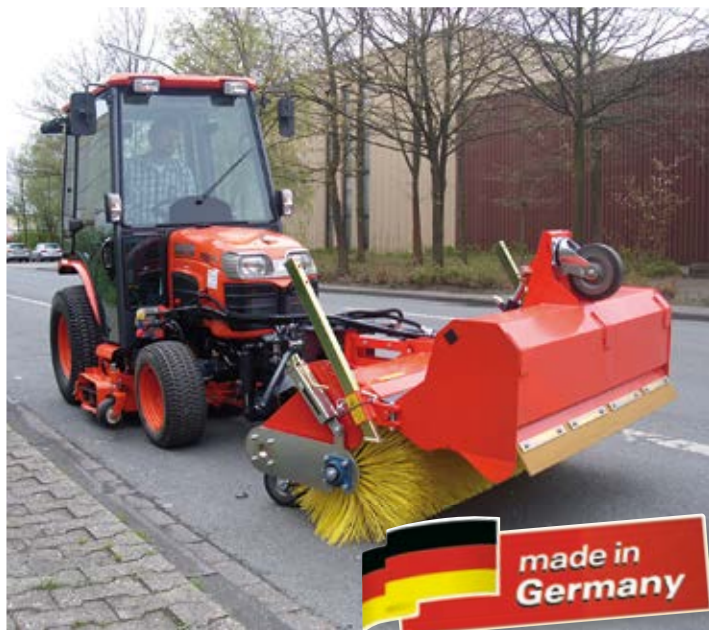
Abstellstütze und stufenlos höhenverstellbare Kehrwalze
