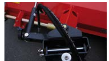
hydraulische Seitenverstellung (optional)
