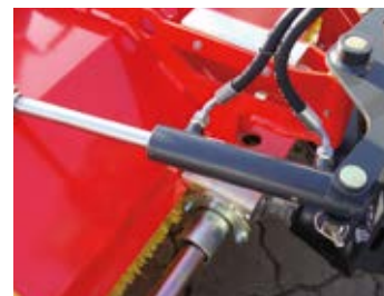
hydraulische Seitenverstellung (optional)
