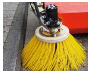
hydraulisch angetriebener Seitenbesen (optional)
