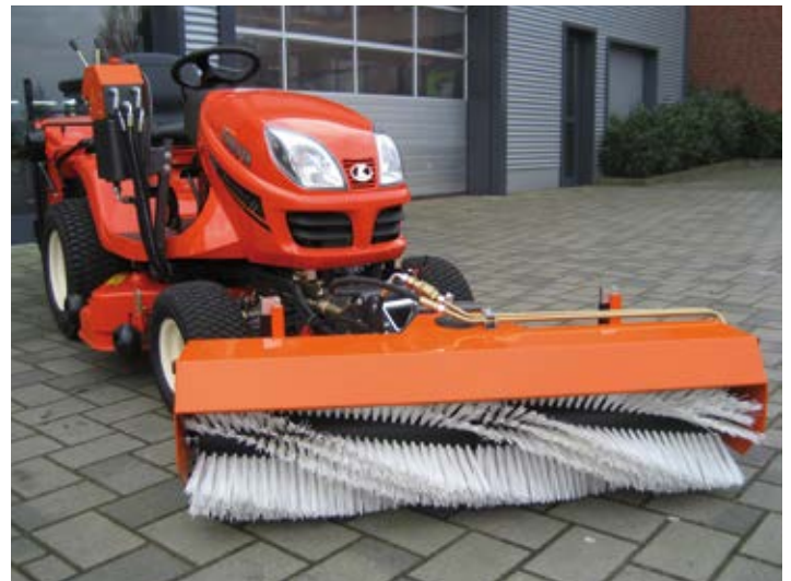
Anbaukehrmaschine mit integrierter hydraulischer Aushebung und hydraulischer Seitenverstellung. Stufenlose Drehzahlverstellung der Bürsten. Ideal zum Kehren von Schmutz und Schnee.
